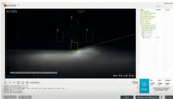
Průběh testování rozsahu světlometu – mechanický pohyb světelným svazkem
