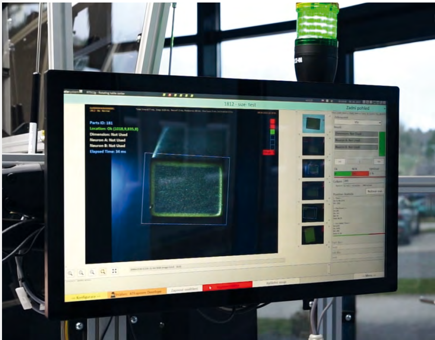
Aplikace kamerové kontroly SMD součástek na skleněném talíři
