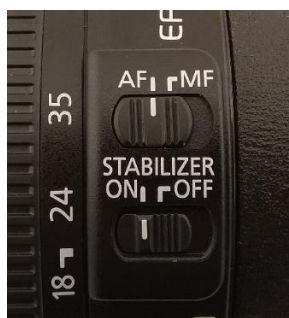
Obr. 3 – Přepínač automatického a manuálního ostření
