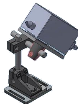
Obr. 7 - Doporučená konstrukce uchycení detekční sondy
