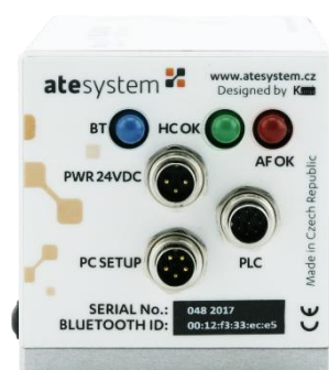
Obr. 4 - Rozmístění LED signalizace a konektorů na zadní straně
