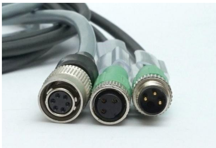
Obr. 3 – Konektory kabelu: zleva konektor Hirose pro připojení kamery, samice M8 pro připojení osvětlovače a samec M8 pro připojení zdroje
